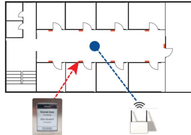
Links sehen Sie ein Beispiel einer Raumbelegung mit unseren digitalen Türschildern (rot markiert). Diese werden zentral per Funk von einem Router aus angesteuert und aktualisiert. Die Montage der Schilder erfolgt ohne Verkabelung. Lediglich der Funkrouter muss via Ethernet angebunden werden. Dieser kann über Power-Over-Ethernet mit Spannung versorgt werden.
