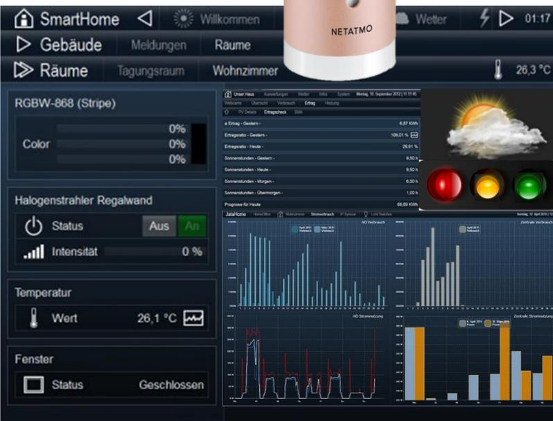
Individuell programmierte IoT-Plattform zur Darstellung unterschiedlicher Sensoren mit aktuellen und archivierten Messwerten. Ebenfalls geeignet zur eventbasierten Schaltung von IoT-Aktoren wie z.B. Luftreiniger oder Fenstermotore.
